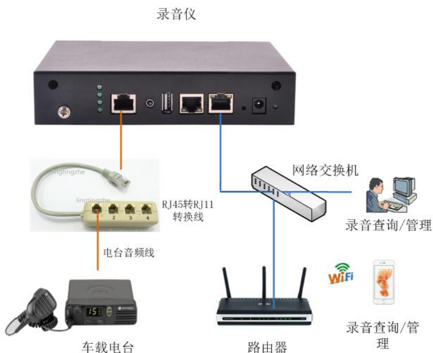
图 1 MDL3004 录音仪组网拓扑图
